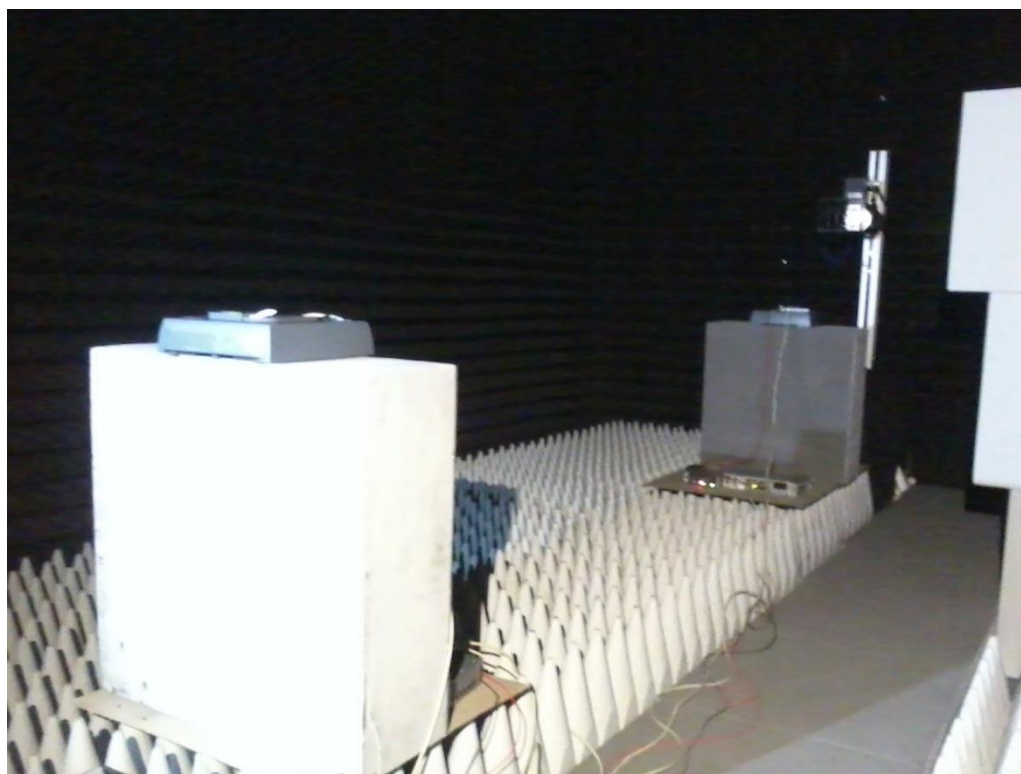
Obrázek 42 Soustava pro porovnávání protokolů v EMC komoře
