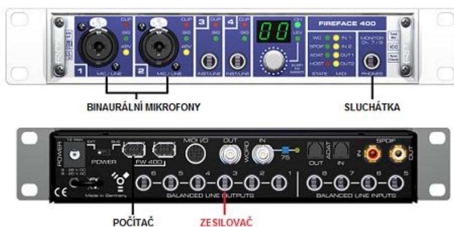
Obrázek 15: Fyzické propojení zvukové karty s ostatními komponenty
