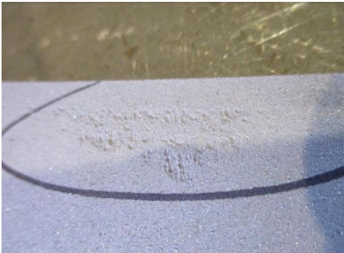
Obr. 13: Poškození spalovací turbíny cizím předmětem, zdroj [11]
