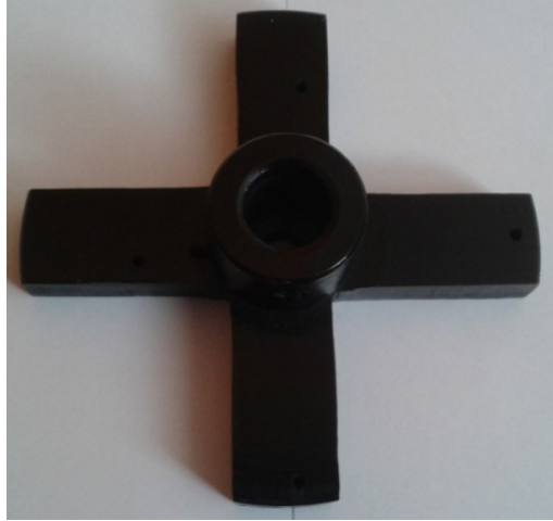
Obr. 36 Kříž z pertinaxu pro upevnění motoru v ose trubky
