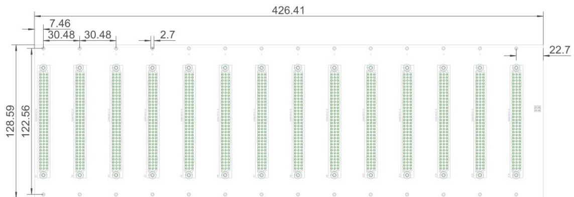
Obrázek 9 - Celkový pohled na návrh rozměrů backplanu (vše v mm)
