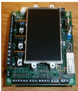
Obrázek 24 - vrchní strana DPS s displejem od firmy 4D Systems
