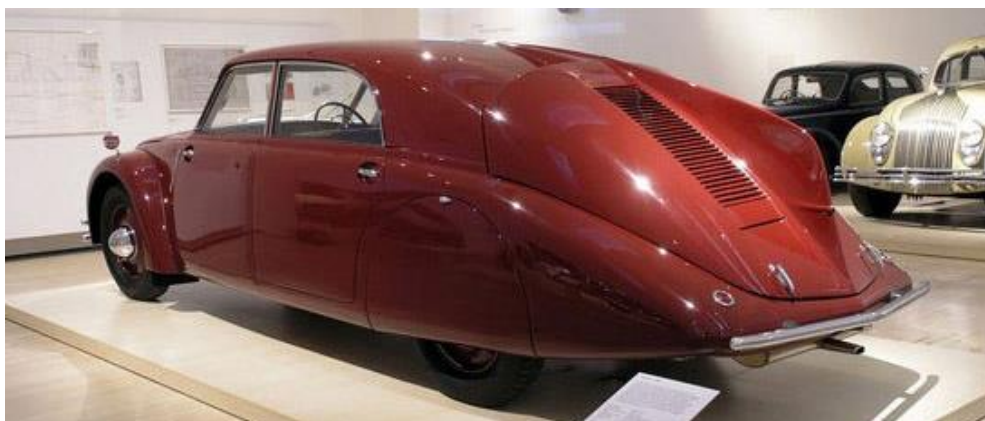
Obrázek 15 – Počátky aerodynamiky u osobních automobilů a proudnicový tvar automobilu Tatra 77 ( C_x = 0,21 ) z roku 1934, navržený Paulem Jarrayem, designérem Erichem Uberlackerem a konstruktérem Hansem Ledwinkou
