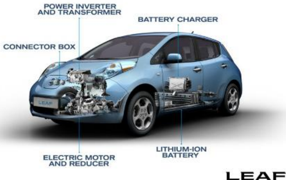
Obrázek 8 - Schéma elektromobilu: Nissan LEAF s elektromotorem vpředu a bateriemi uloženými pod podlahou
