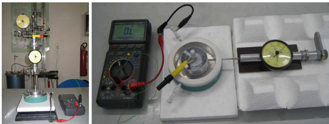
Obr. 6.8 Měřící pracoviště pro měření zatížení v axiální (vlevo) a radiálním (vpravo) směru [17]
