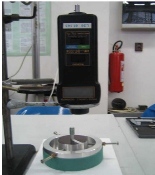
Obr. 6.9 Měřící pracoviště pro stanovení závislosti otáček na čase [17]
