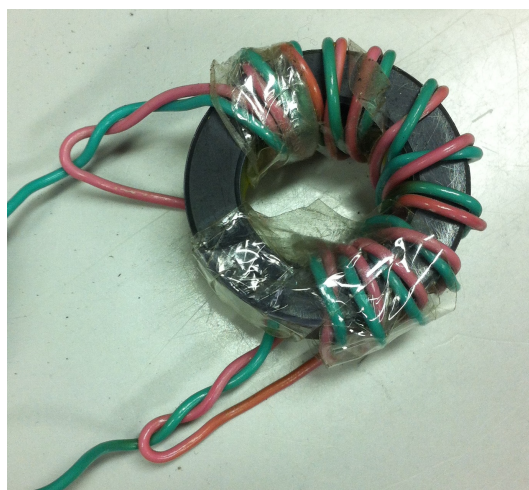
Obrázek 4.8: Feritový toroidní transformátor pro měření se spektrálním analyzátozem a pro měření průběhu proudu bez stejnosměrné složky
