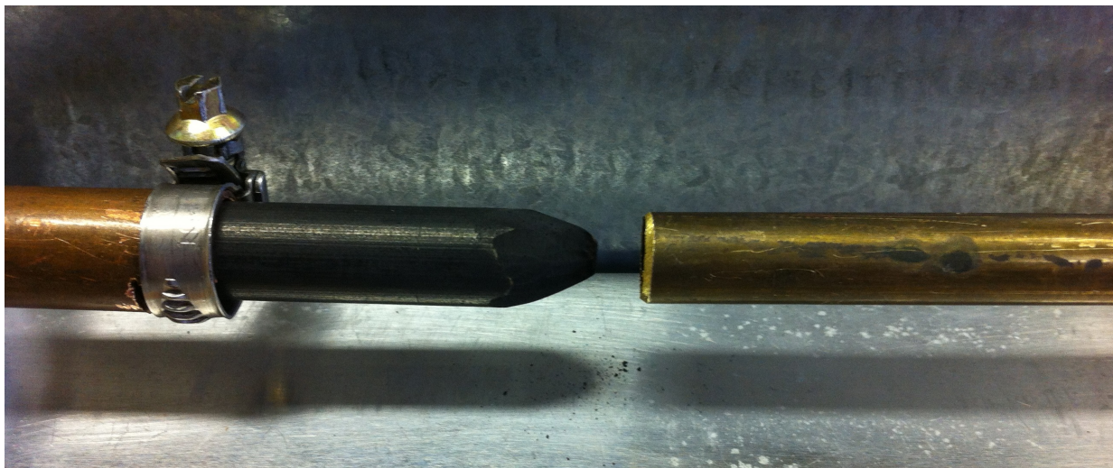
Obrázek 4.2: Detail jiskřiště generátoru elektrického oblouku realizovaného pro laboratorní pracoviště AFDD
