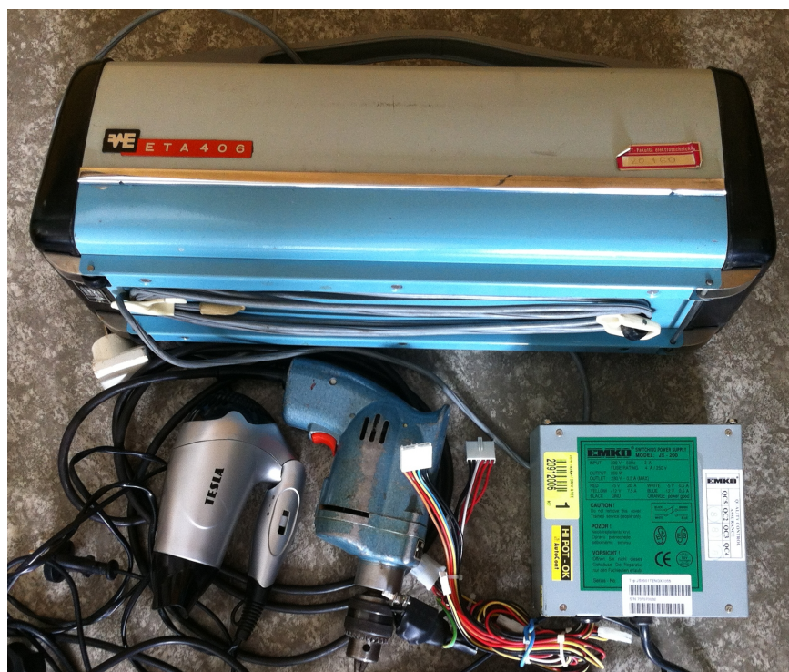
Obrázek 5.4: Některé spotřebiče použité pro zkoušku s maskovacím rušením
