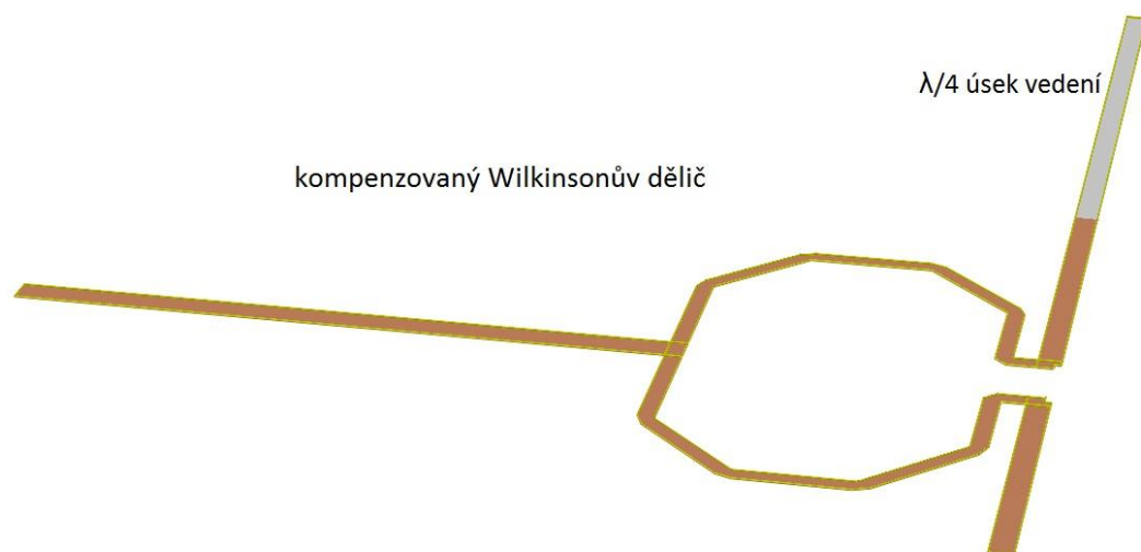
Obr. 21 - Schéma kompenzovaného Wilkinsonova děliče s \lambda/4 úsekem vedení
