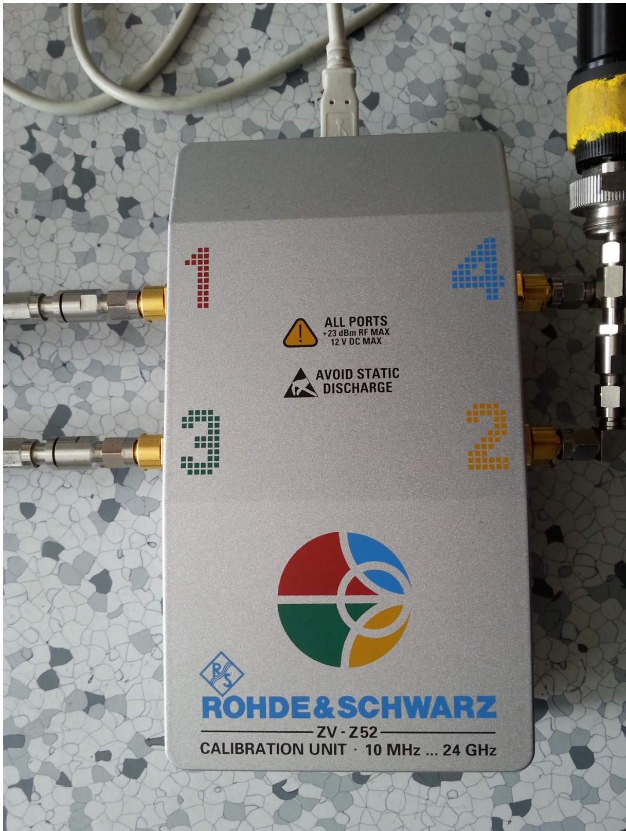
Obr. B3 - Kalibrační jednotka Rohde&Schwarz ZV-Z52
