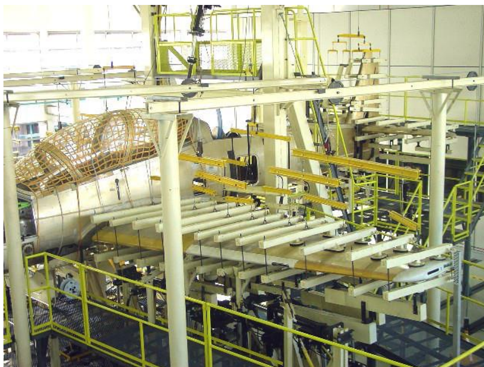
Obr. 1 - Příklad životnostního strukturálního testu při působení obecného zatěžování na křídlo letadla Embraer EMB 314 [16]
