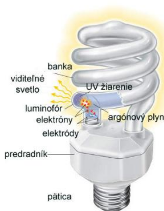
Obr.7: Nízkotlaková ortuťová výbojka- žiarivka [31]
