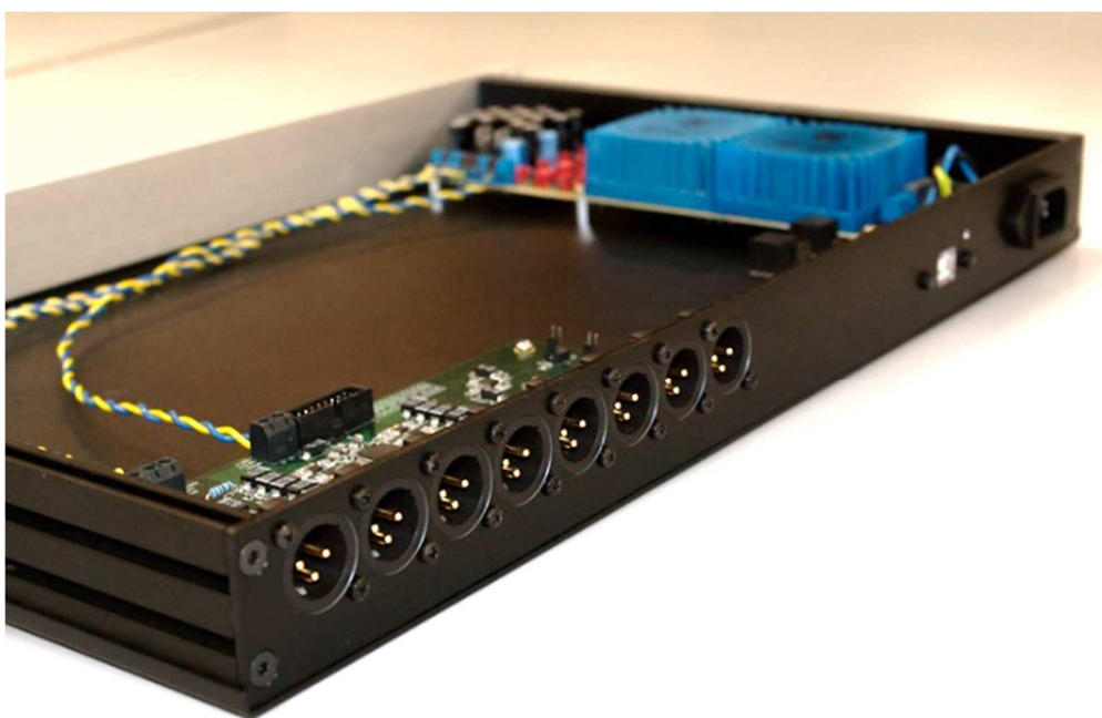
Ilustrace 5.1: Zadní panel s D/A modulem během montáže přístroje
