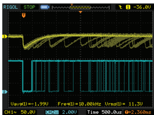
Obr. 4.2.3 – Mrtvá doba trubice LND 712
