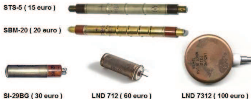
Obr. 2.1.3 – Srovnání několika typů G-M trubice (včetně orientační ceny v Eurech) [9]
