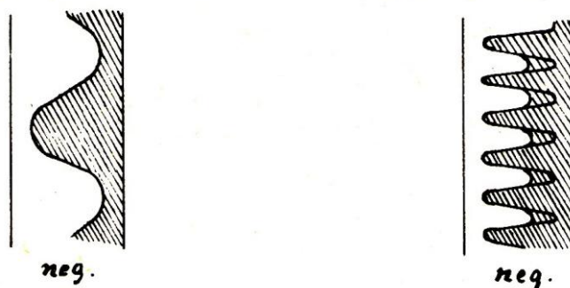
Obrázek 2.4 - Jednostranný záznam optické zvukové stopy, vpravo je ilustrováno tzv. zalití důlů v záznamu [2]
