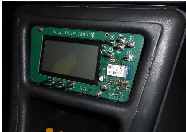
Obrázek 5.4. montáž čelního panelu
