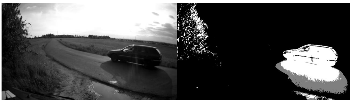
Obr. 10.6: Auto a pohybující se větve stromů detekované algoritmem MoG2
