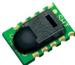
Obr. 5.1: Senzor vlhkosti a teploty SHT11
