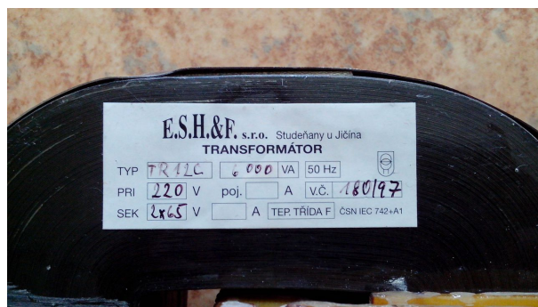
Obr. 16 Štítkové údaje měřeného transformátoru
