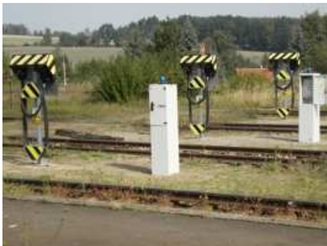
Obr. 12 Elektrické předtápěcí zařízení
