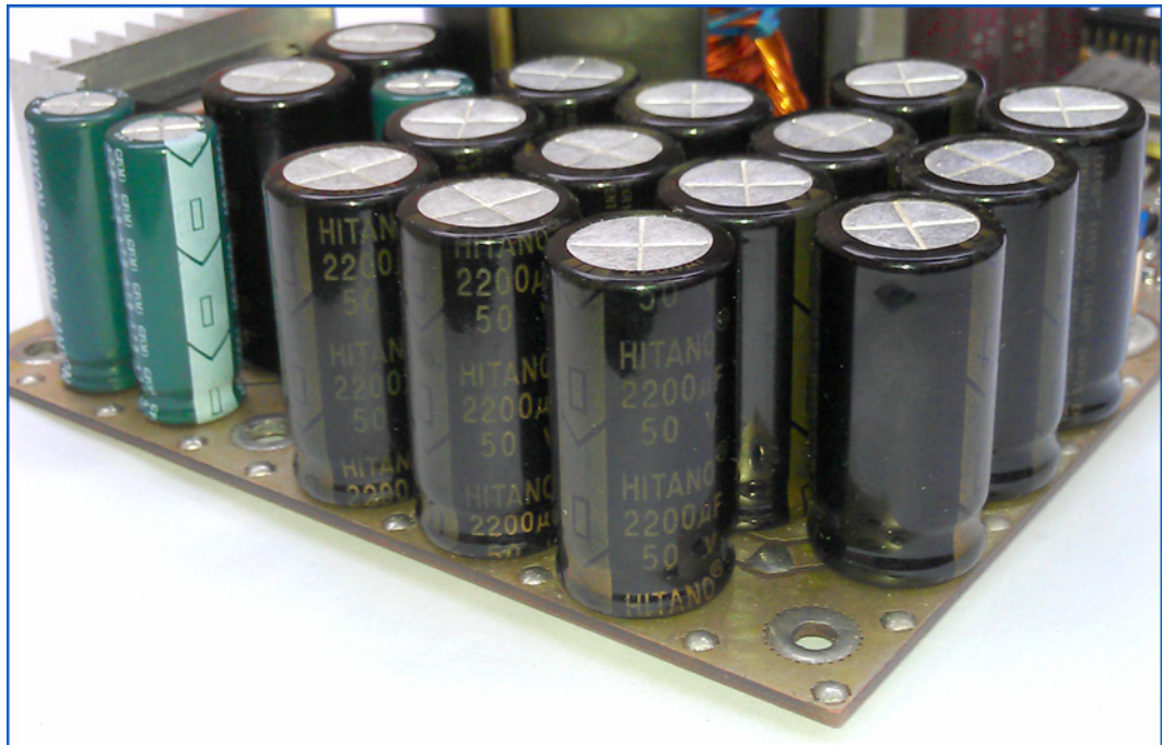
Obrázek 6.19 : Ukázka baterie výstupních filtračních kondenzátorů měniče po osazení
