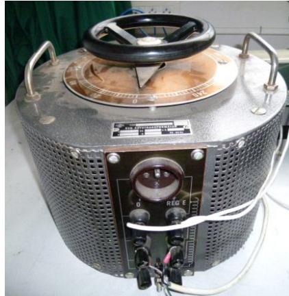
Obr. č. 3.9: Autotransformator ZPA Prešov, RA 10
