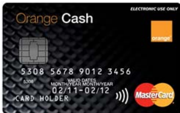
Obrázek 2.: Bezkontaktní Orange platební RFID karta od karetní společnosti MasterCard (ISO/IEC 14443), Zdroj: http://www.fasano.co.uk/administrator/Editor/assets/Orange_Cash_250.jpg
