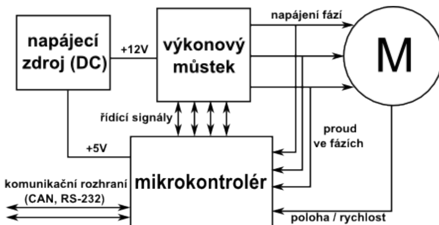
Obr. 19. Kompletní schéma součástí potřebných k vektorovému řízení BLDC motoru
