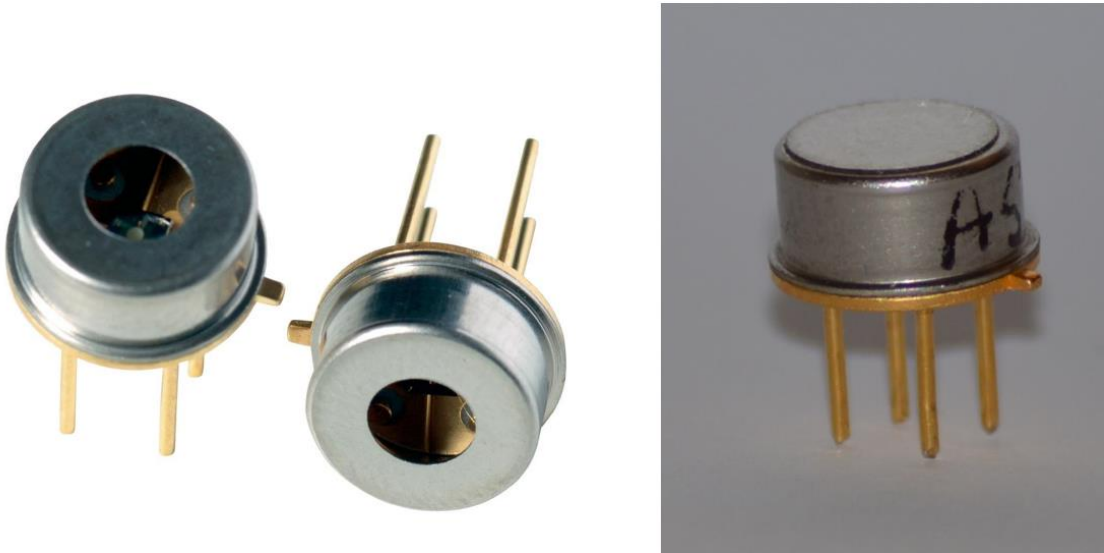
Obr. 8 Fotografie senzoru AS-MLx bez filtru (vlevo) a s filtrem (vpravo)
