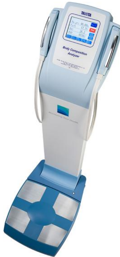
Obrázek 13 – Příklad přístroje pro segmentální BIA. Jsou zřetelné čtyři elektrody pod chodidla, další dva páry elektrod jsou na vyndavacích madlech pro ruce. Zobrazena je bioimpedanční váha Tanita MC 180MA ( www.tanita.com )
