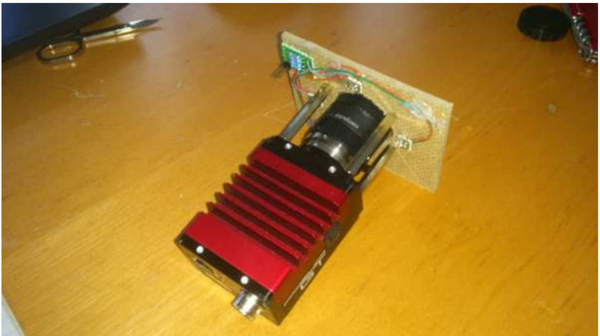
Obr. 34 Prototyp záměrného kříže – zapojení
