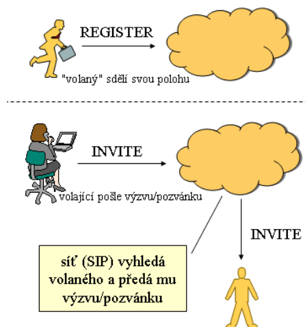
Obr. 2.2: Navazování spojení v SIP [2]
