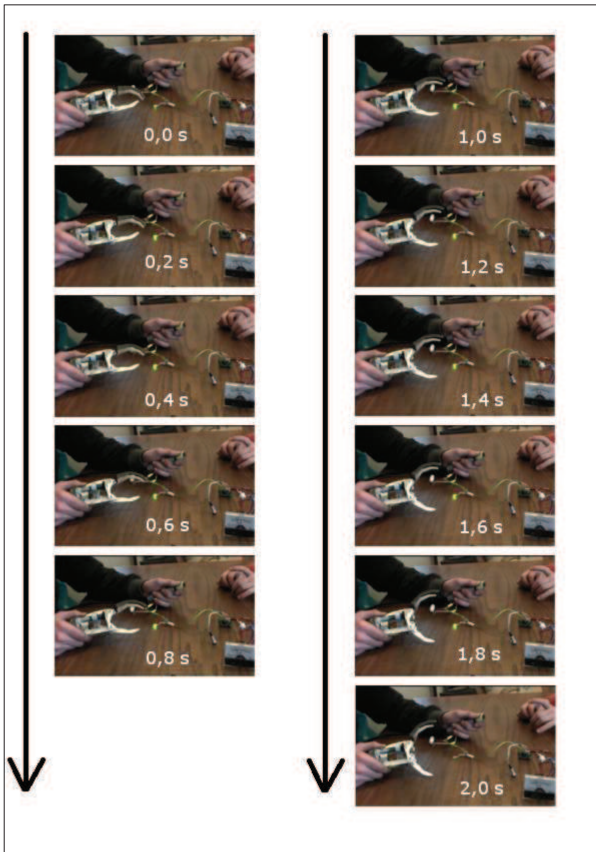
Obr. č. 40 - Časový průběh zavírání protězy. Odstup snímků je 0,2 s.
