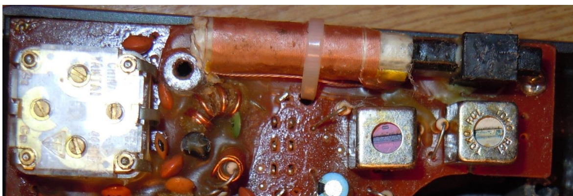
Obr. 20 Feritová anténa a ladící kondenzátor
