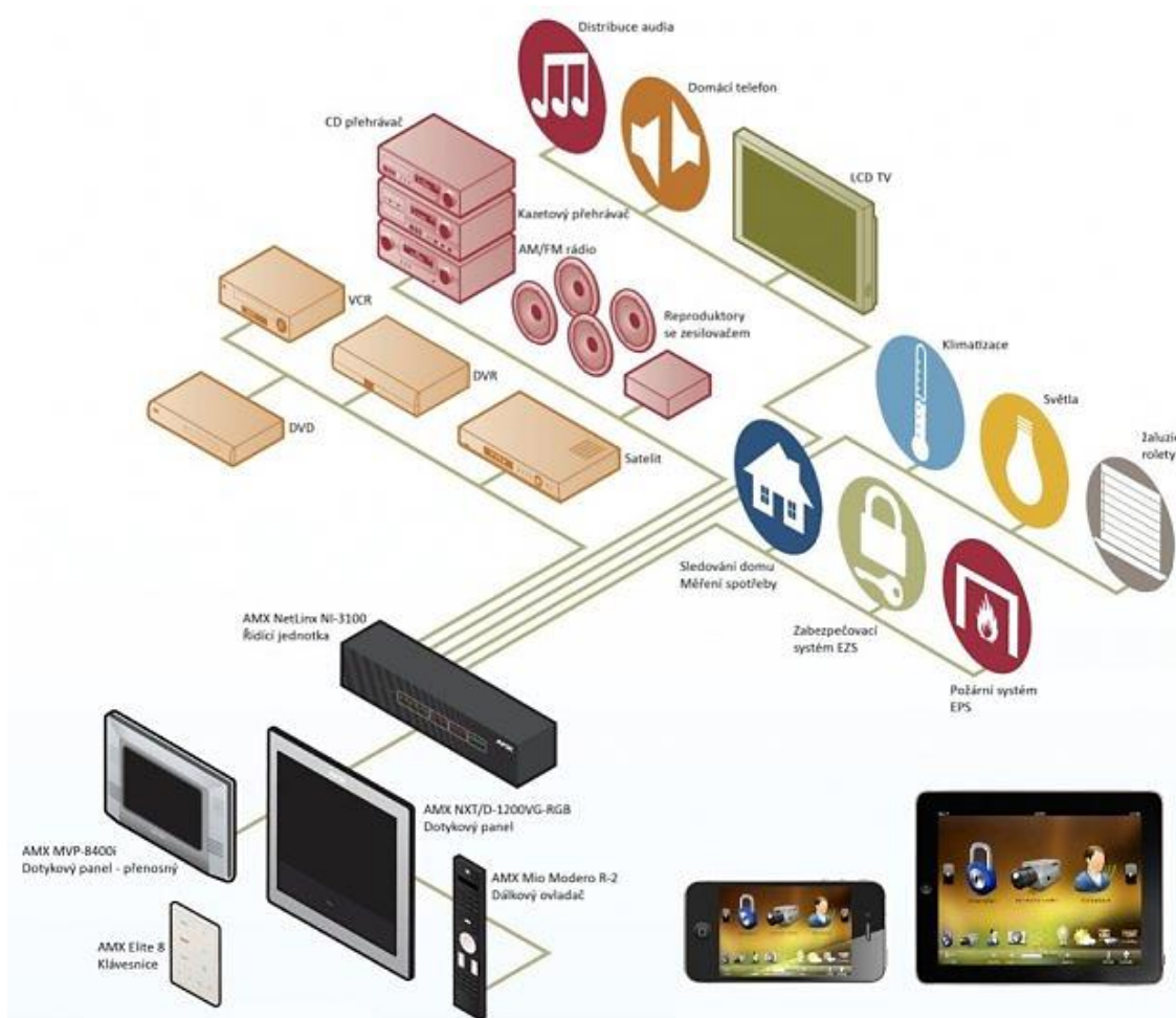
Obr. 3: Propojení technologií v inteligentním bytu [13]
