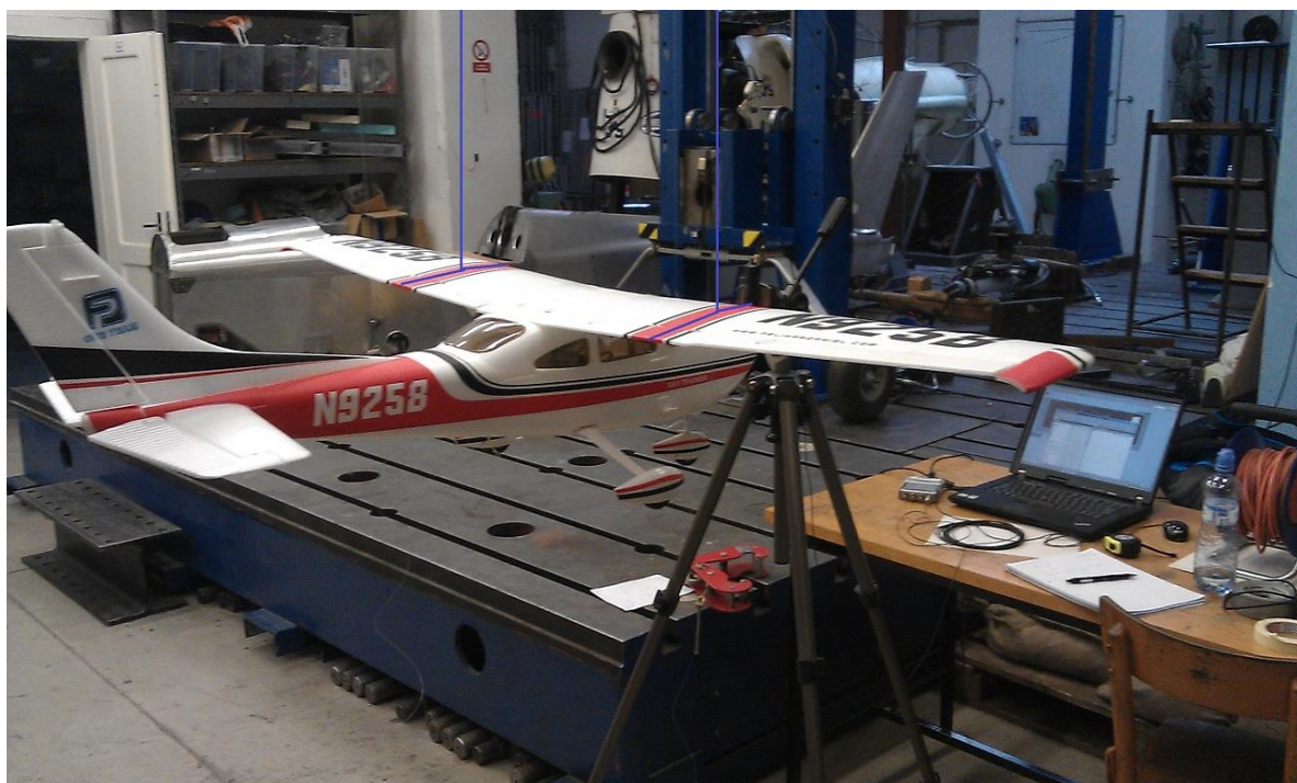
Obrázek 3.4: Ukázka měření momentů setrvačnosti
