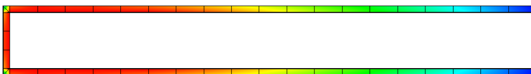
Obr. 3.12: Ohnutý dipól (var. 2), proudové rozložení v rezonanci
