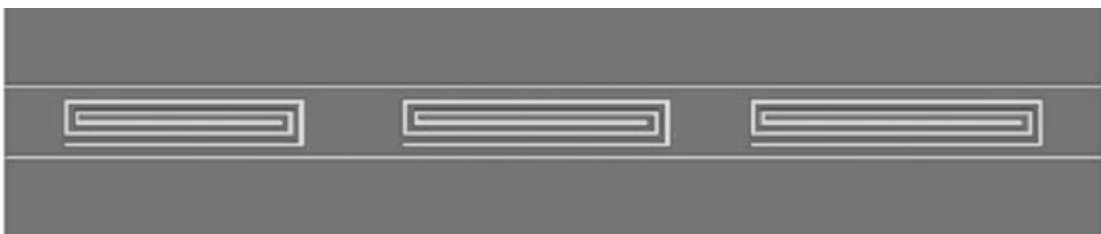
Obr. 1.9: Rezonátory navázané na koplanární vedení
