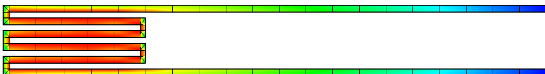
Obr. 3.16: Ohnutý dipól (var. 4), proudové rozložení v rezonanci
