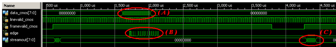
Fig. 6.5 Simulace VHDL kódu – klíčové signály
