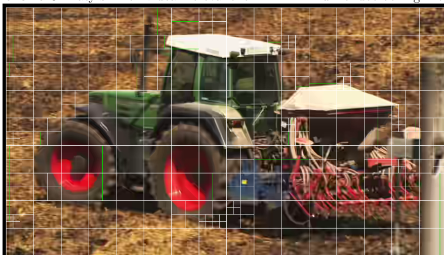
Obrázek 7.7. Pátý snímek videa s vyznačenými hranicemi CTB, CU, PU a TU pomocí nástroje sherlock265
