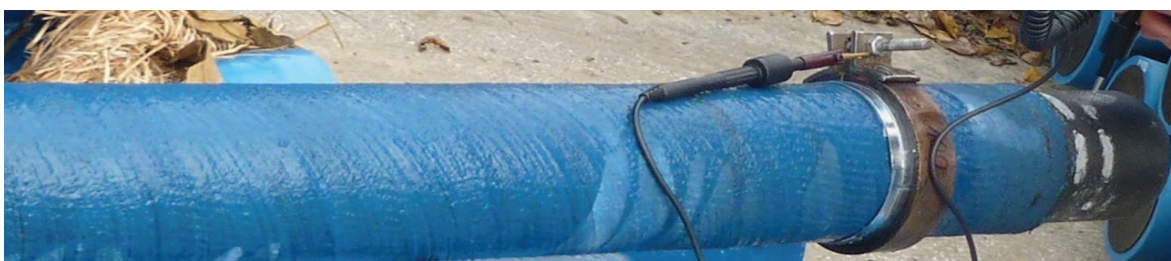
Obrázek 4.4: Ukázka provedení kovové objímky pro měření izolačního odporu OCM
