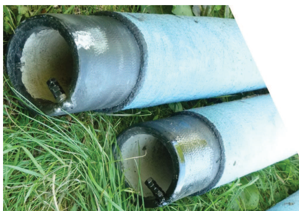
Obrázek 4.13: Návarek pro připojení vodičů ke zdroji DC proudu
