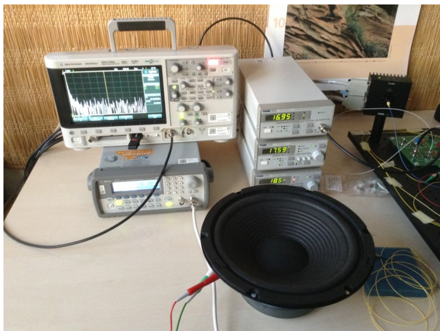
Obr. 6.1.2 Měření známé frekvence reproduktoru – měřící pracoviště
