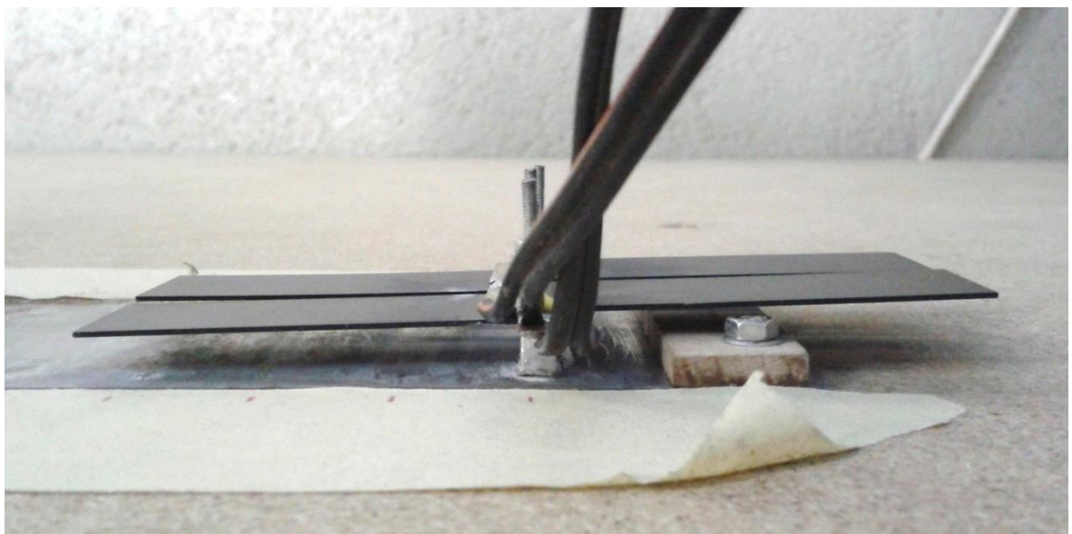
Obrázek A.2 Detail přichycení měniče v poloze 1
