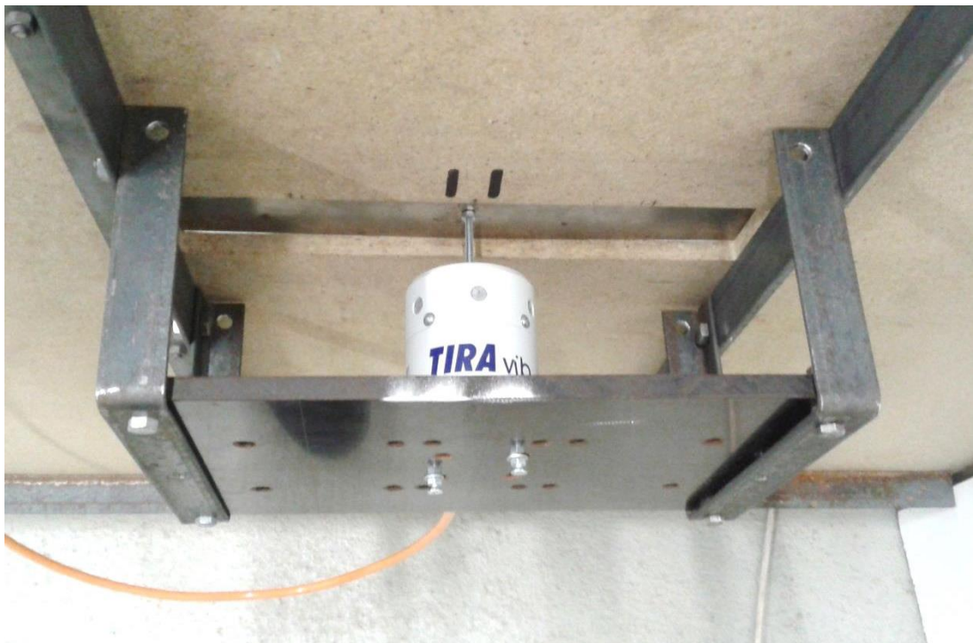
Obrázek A.4 Uchycení shakeru na výztužné konstrukci ze zadní strany pásu
