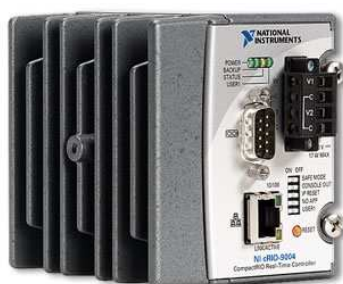
Obrázek 5.1: Fotografie řídicího systému NI cRio 9004, převzato z [17]
