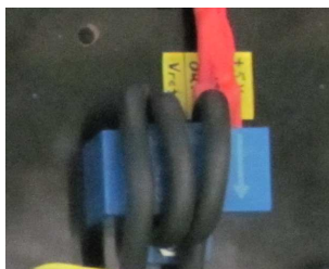
Obrázek 4.2: Uchycení LEM sondy v rozvaděči
