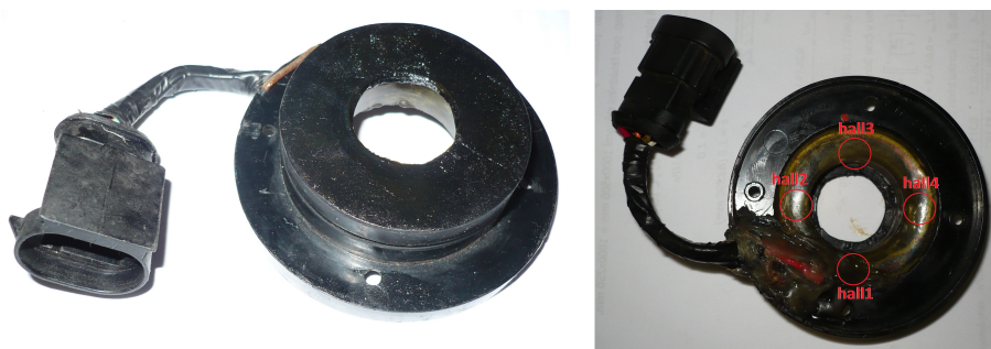
Obrázek 4.15: Snímač polohy vačkové hřídele s Hallovými sondami
