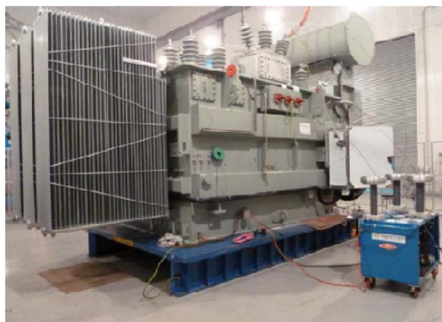
Obr. 31 - PST ve Wissingtonu, Norfolk a) parametry b) při zkouškách v Austrálii[25, str. 6]
