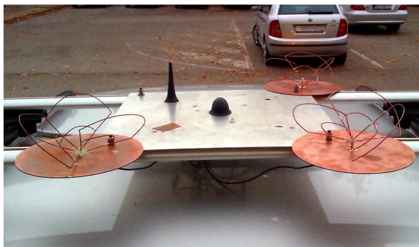
Obrázek 27 Antennní systém na střeše testovacího vozu.
