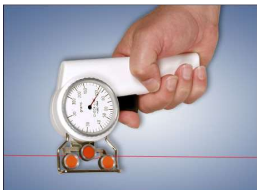
Obrázek 1.7: Tenzometr měřící napětí lanka
