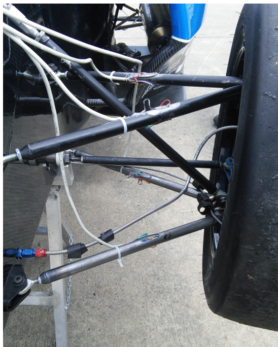
Obrázek 5.5: Finální instalace - ramena s tenzometry levého předního kola
