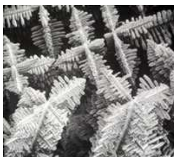
Obr.:10 - Detailní pohled na krystalickou strukturu PbSO_4 [9]
