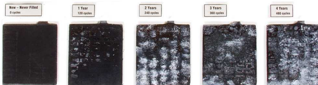
Obr.:8 - Postupný růst sulfatace elektrod [5]
