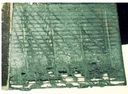
Obr.:6 - Naleptání záporné elektrody [21]
