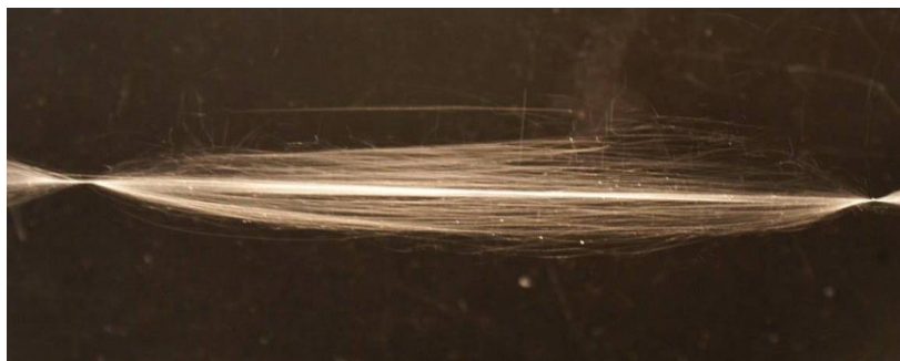
Obrázek 33: Odpuzování nanovláken ve vnějším poli
