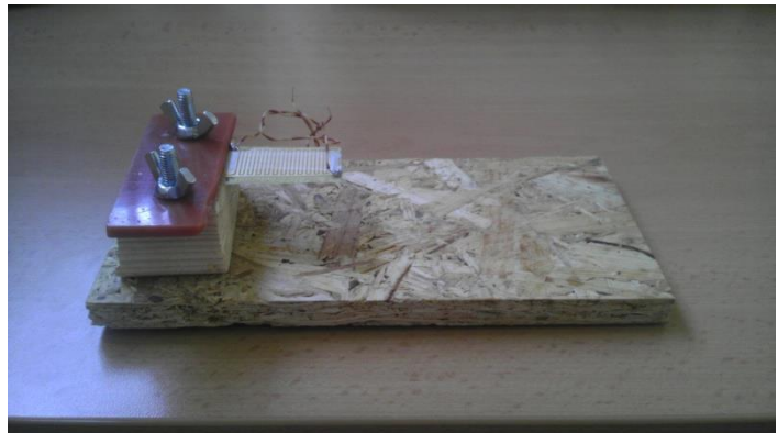
Obrázek 35: Aparatura pro měření na ohebných deskách
