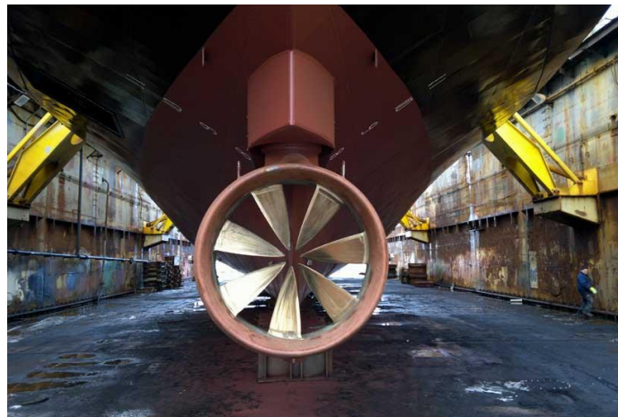
Obrázek 8: Projekt firmy Fjord1 MRF – speciální lodní šroub pohánění prstencovým motorem
