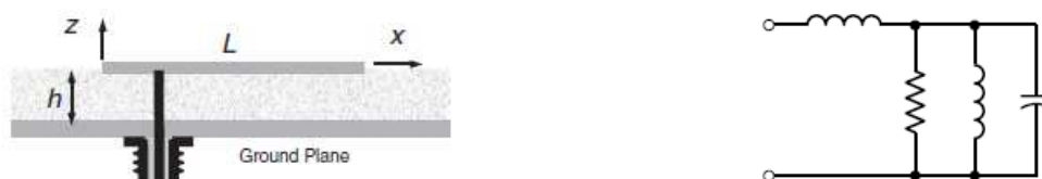
Obr. 7.1 - Napájení patchové antény koaxiální sondou a náhradní schéma antény s parazitní indukčností [23]
