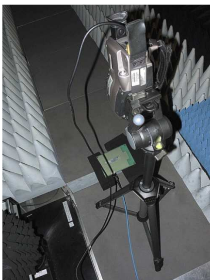
Obr. 7.4 - Měření ohřevu antény termokamerou
