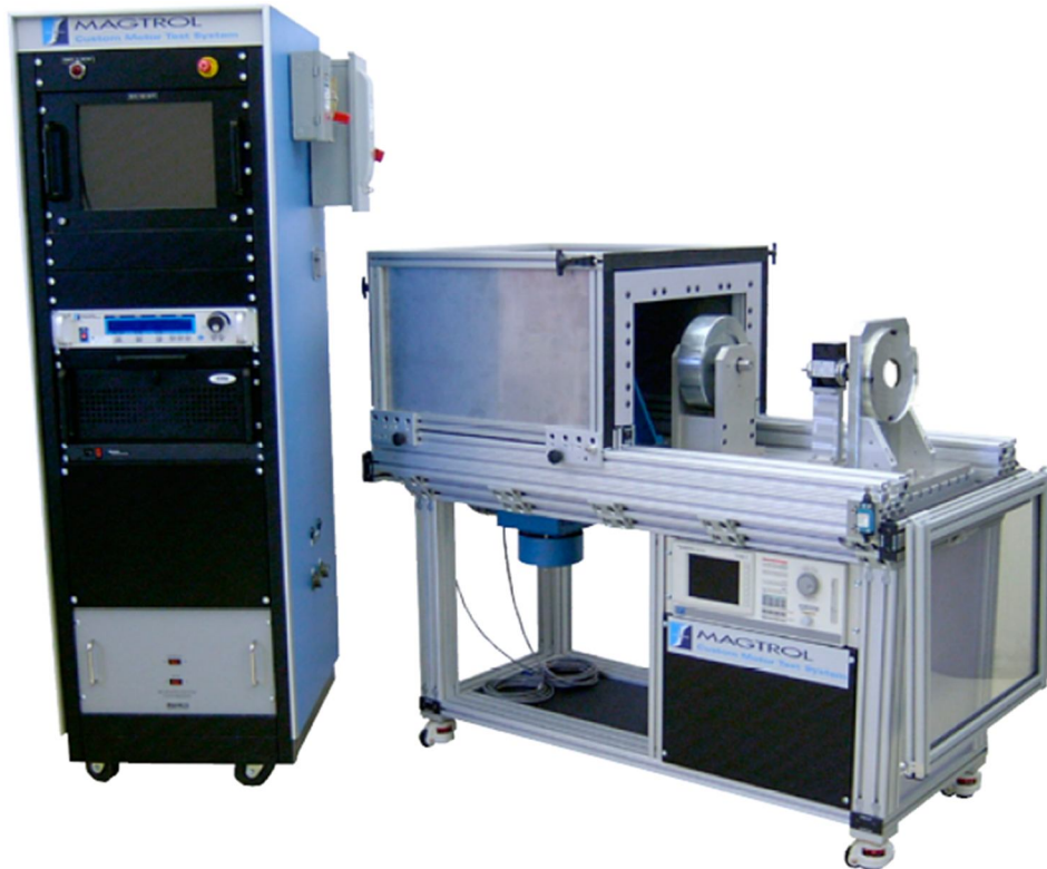
Obr. 4.7 Pracoviště určené pro testování motorů do spotřebičů
