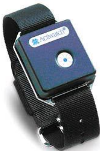
Obr. 1: Typický aktigraf ve tvaru hodinek, převzeto z [1]
