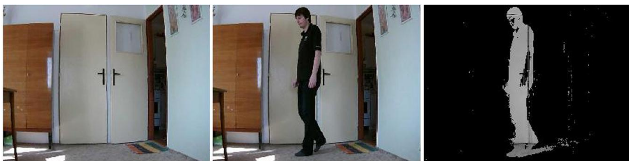
Obr. 11 - Odečítání předzpracovaného pozadí Zleva: pozadí, snímek i , rozdílový snímek
