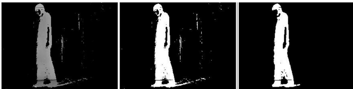
Obr. 17 - Úprava obrázku Zleva: původní obrázek, prahovaný obrázek, uzavřený obrázek
