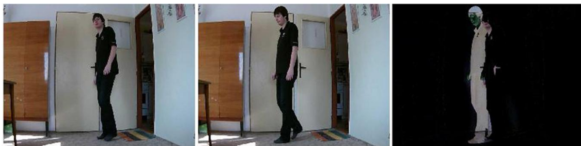
Obr. 9 - Odečítání po sobě jdoucích snímků Zleva: frame i , frame i+1 , rozdílový snímek
