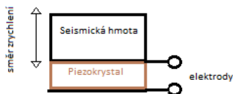
Obr. 5 Konstrukce piezoelektrického akcelerometru
